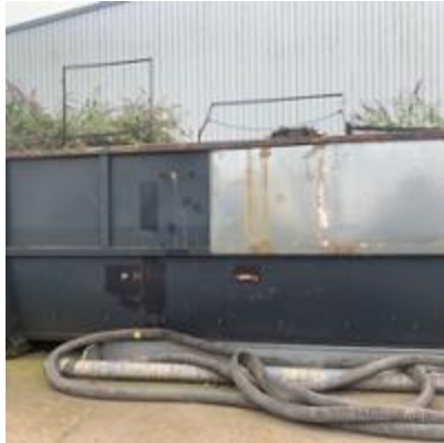
Silt Separator Unit
